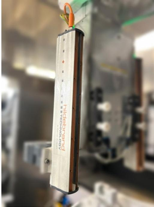
Entladestab **iONstream 4.0**, 2fach am Robotorarm angebaut
